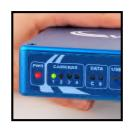
7. 車を空が広く見える場所へ移動させて、計測に必要な衛星を捕捉させます。 適切な衛星数を捕捉するまでに5分ほど時間がかかります。 適切な衛星数が捕捉されると'GPS' LED が緑色に点灯します。
