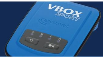
VBOX Sport は、車両測定やラップタイム計測に適した GPS/GLONASS データロガーです。防水性を持っており、内蔵バッテリーで駆動させることができます。
