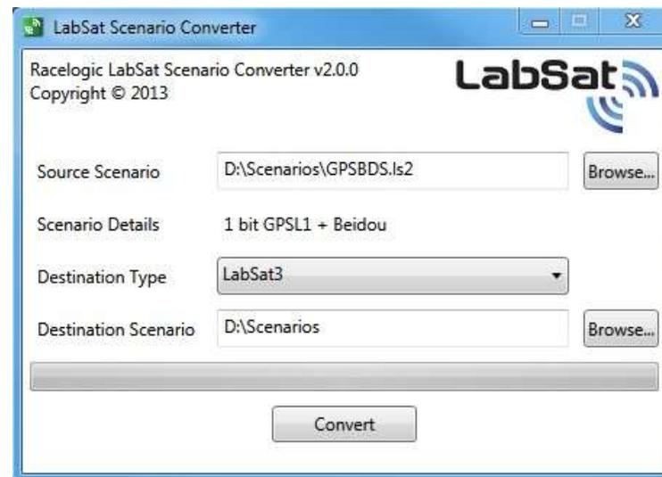
Source Scenario の右横にある Browse ボタンをクリックすると、変換したい LabSat シナリオを指定することができます。LabSat Scenario Converter tool は自動的に LabSat シナリオを LabSat3 シナリオ(拡張子 \*.ls3) に変換します。
