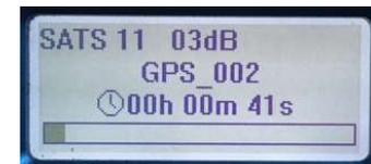
再生中に、OK ボタンを押すと、内部 GNSS 受信機によって捕捉された衛星信号レベルのバーグラフが表示されます。内部 GNSS 受信機は、現在は GPS と GLONASS のみに対応しています。このことは BeiDou からの信号を記録・再生には影響を与えず、BeiDou の記録再生に問題はありません。バーグラフ表示中に、▲▼ボタンで GPS と GLONASS の表示を切替えます。表示を切り替えた場合は、内部 GNSS 受信機が衛星信号レベルを再度認識するために少し時間がかかります。特に GLONASS を選択した場合は衛星信号情報を表示するまでに 1 分以上(長い時で 1 5 分程度)かかります。
