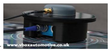
最新の IMU 補正では、右写真のような IMU とアンテナを一体にして、ルーフに取り付ける方式を採用しています。アンテナと IMU の位置関係が正確にわかることにより、より効果の高い補正を実現可能にしています。
