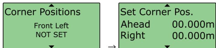
3) GPS アンテナ A から、車両の左フロントまでの距離を入力します。用語の向きは右図の通りです。
