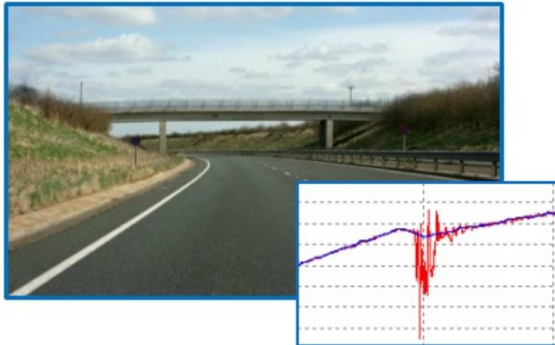
左図はIMU補正を行った速度のグラフです。データは橋のある道路で測定されたものです。赤のラインはGPSのみのデータ、青のラインがIMU補正を行ったデータです。
