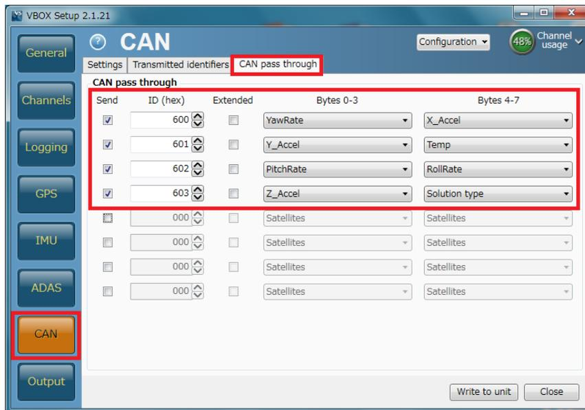
Extra Tx Identifiers で設定した CAN 出力を受信する場合は、以下のように設定をしてください。データタイプが 32bit float なので、ご注意ください。
