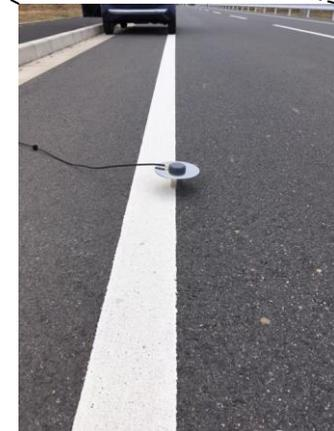
道路上に金属板とともに設置した GPS アンテナ
